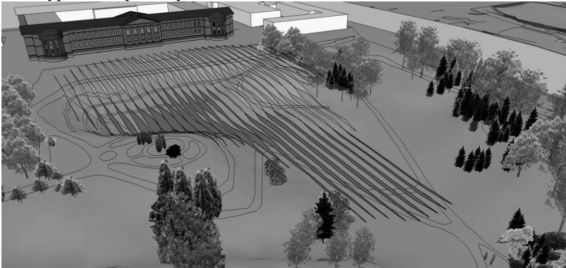
Фото 10. Схема переміщення ґрунту з зон, позначених світлими площинами, у зони, позначені темними площинами.
