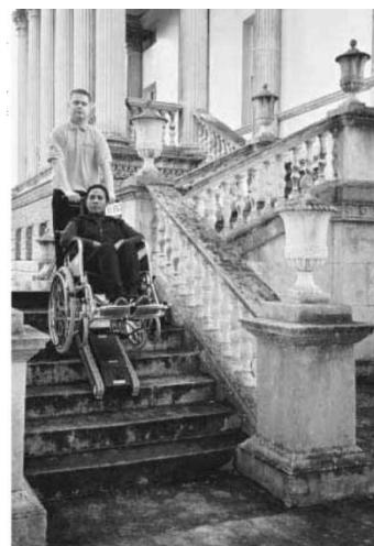
*Рис.13. Автономний мобільний сходовий підйомник на гусеничному ходу*
