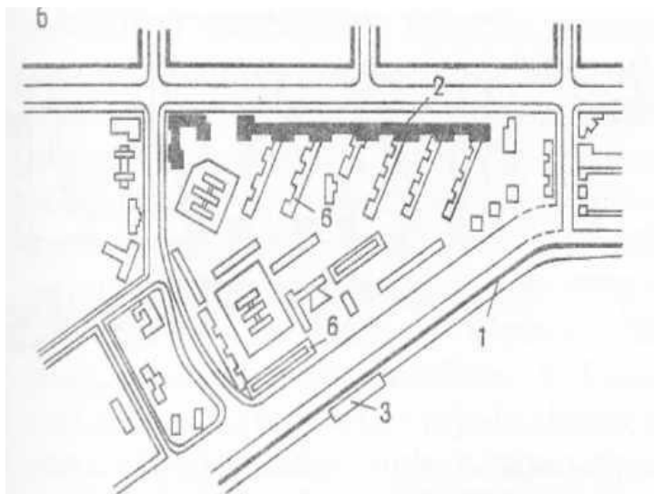
Рис. 3. Захист від шуму житлового району за допомогою магазинів-екранів і стінки-екрану.
