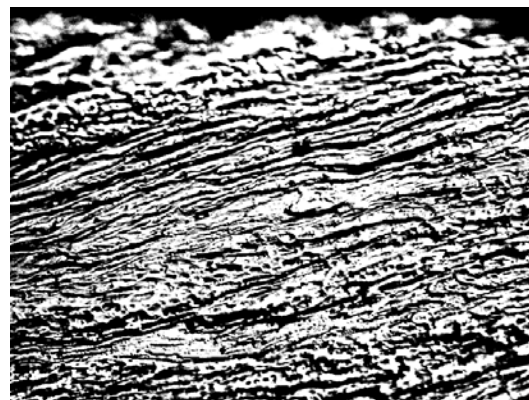
а – общий вид, \times 50 , б – периферия образца, \times 400 Рисунок 3 – Микроструктура поперечного сечения образца стали 08пс после КГД, N=5
