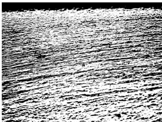
а – общий вид, \times 50 , б – периферия образца, \times 400 Рисунок 3 – Микроструктура поперечного сечения образца стали 08пс после КГД, N=5
