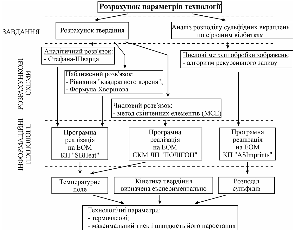
Рисунок 1 – Схема, що ілюструє загальну методику визначення технологічних параметрів на прикладі сталевого виливка
