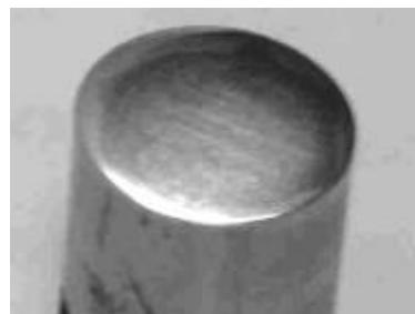
Рисунок 3 – Общий вид поперечного сечения многослойного проката быстрорежущей стали Р6М5 диаметром 14 мм (4x)
