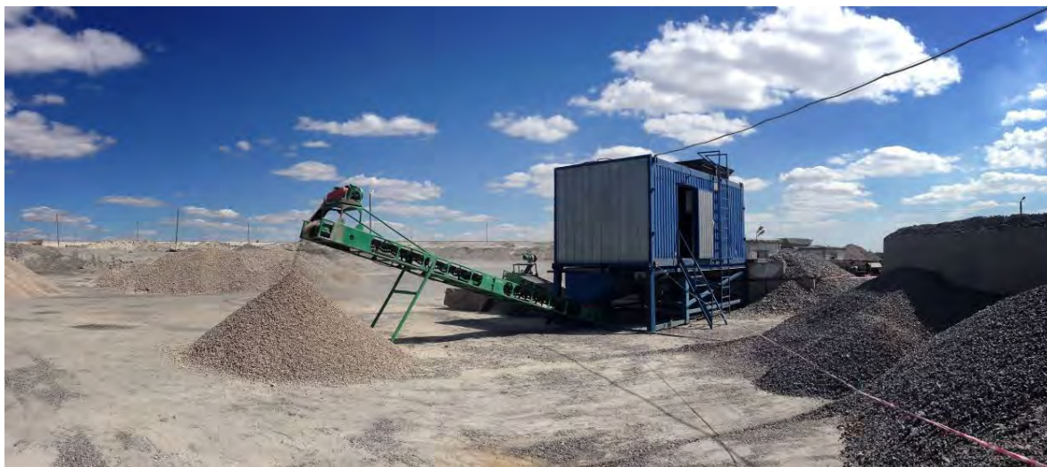
Рисунок 3 – Испытательный участок по сортировке шлаков рафинированного феррохрома. Казахстан, АО «ТНК «Казхром»
