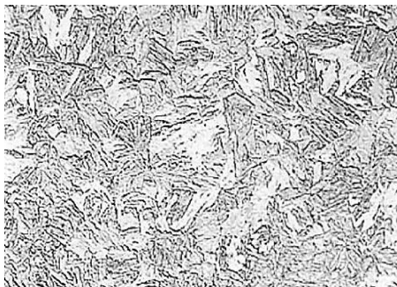
Рисунок 5 - Мікроструктура (Ч500) низьковуглецевої марганцевої сталі, легованої кремнієм [14]
