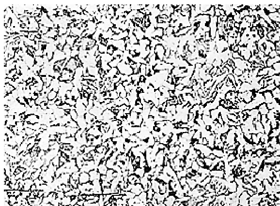
Рисунок 4 – Ферито-перліто-бейнітна мікроструктура (Ч100) марганцевої сталі легованої ванадієм [14]
