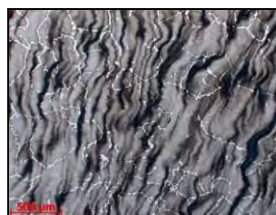
Рисунок 3 – «Следы» бывшей дендритной структуры в микроструктуре образцов стали марки ER 7, Ч 50
