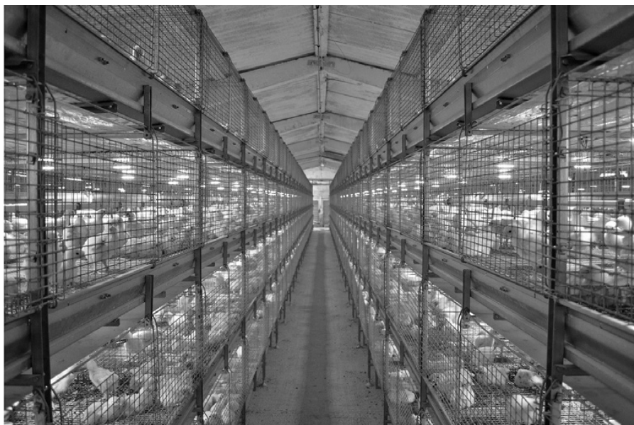
Рис. 1. Клеточная батарея для выращивания цыплят-бройлеров с механизированной выгрузкой птицы на убой
