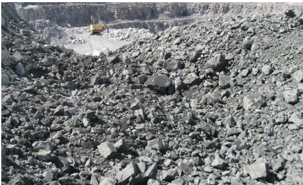
Рисунок 1 – Общий вид развала взорванной горной массы
