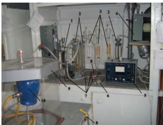
Рисунок 1 – Загальний вигляд установки для випробувань респіраторів:
