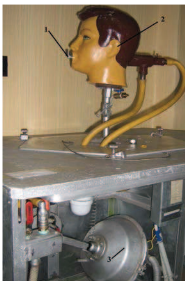
Рисунок 2 – Дихальна машина з муляжем голови: 1 – пробовідбірник із підмаскового простору ЗІЗОД; 2 – шеффілський муляж голови; 3 – дихальна машина
