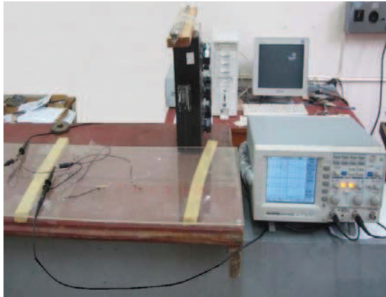
Рисуюнок 5 – Стенд для визначення швидкості поширення динамічних збурень
