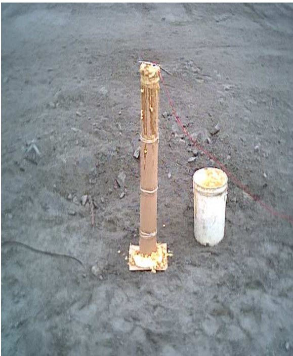
Рисунок 1 – Внешний вид опытного заряда в картонной гильзе диаметром 130 мм
