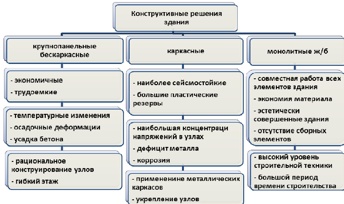
Рисунок 3 – Схемы решения зданий и их основные проблемы в зоне сейсмичности
