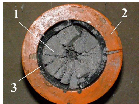
Рисунок 5 – Образец горной породы во взрывной камере после разрушения: 1 – образец; 2 – взрывная камера; 3 – демпфирующая прокладка
