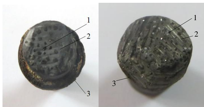
Рисунок 2 – Експериментальний зразок після відпрацювання, вид зверху: зі «Славутича», 1– алмазне зерно; 2 – матриця; 3–державка; – а; зі складом матриці: Ni (70%), Cu (20%), Sn (10%), оснащений термостійкими моно-кристалічними синтетичними алмазами АС160Т 415/350 мкм
