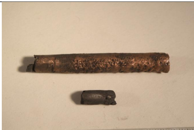
Рисунок 2 – Цилиндрические штабики в оболочках после уплотнения взрывом
