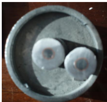
Рисунок 2 – Цилиндрические штабики в оболочках после уплотнения взрывом
