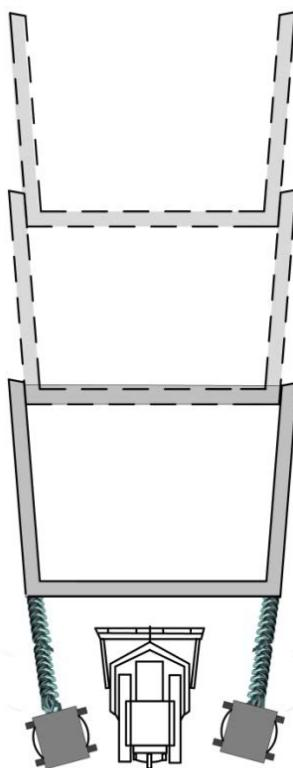
Рис. 2. Растврубний принцип кріплення елементів
