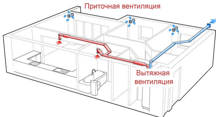
Рис. 1. Схема припливно-витяжної вентиляції
