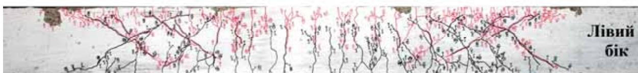
Рисунок 1 – Утворення нормальних і похилих перехресних тріщин на бічних поверхнях балки (серія 2, дослід №17) з поділом її на окремі блоки перед руйнуванням при малоцикловому знакозмінному навантаженні при  $\eta = \pm 0,65 F_u$
