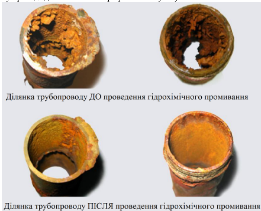
Рисунок 2 – Результати гідрохімічного промивання
