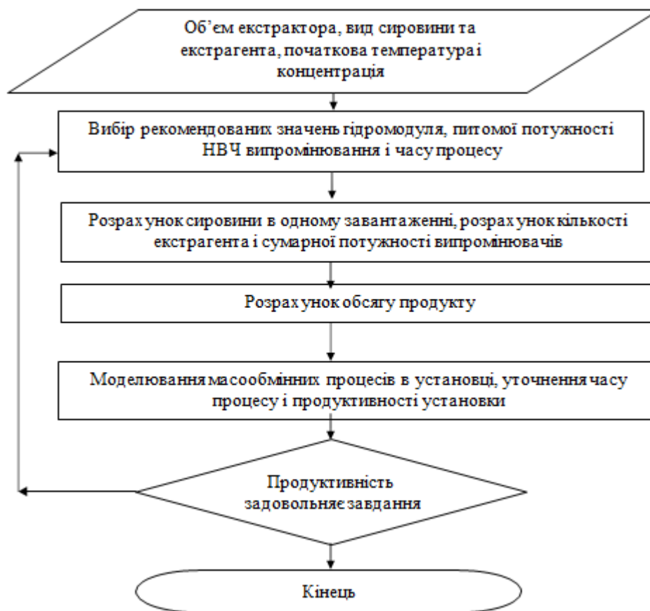
Рисунок 1 – Узагальнена структура алгоритму розрахунку екстрактора з електромагнітним інтенсифікатором
