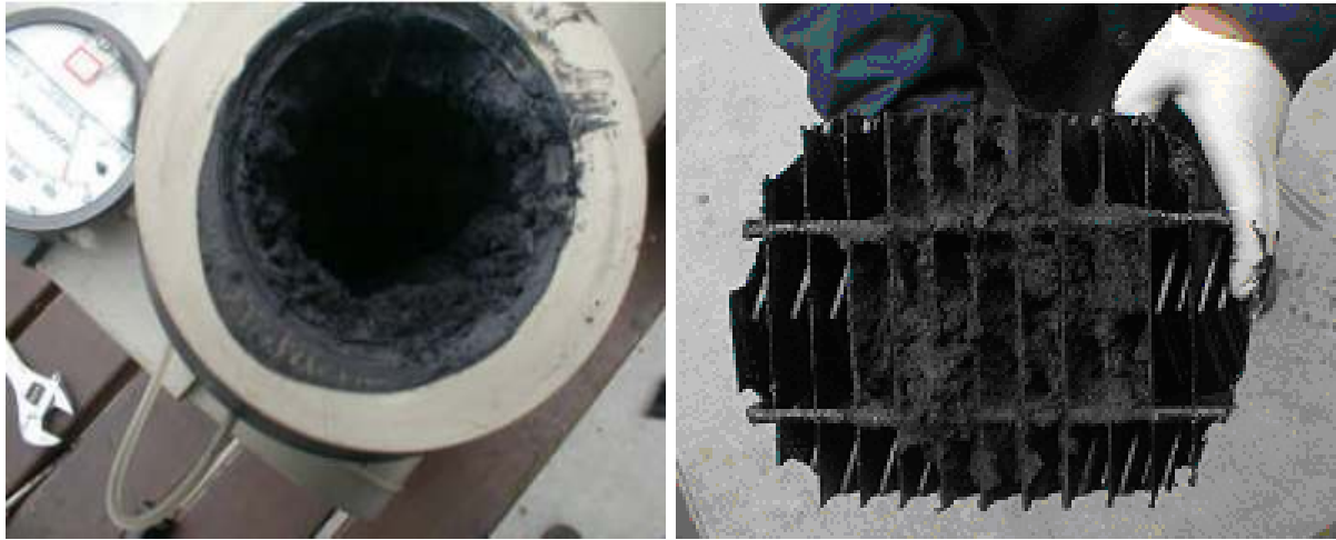
Рисунок 1 – Забруднення обладнання смолою [3]
