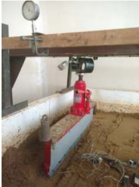
Рисунок 1 – Випробовування моделі фундаменту у дослідному лотку
