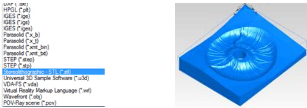
Рисунок 5 – Створення управляючої програми для станка з ЧПУ
