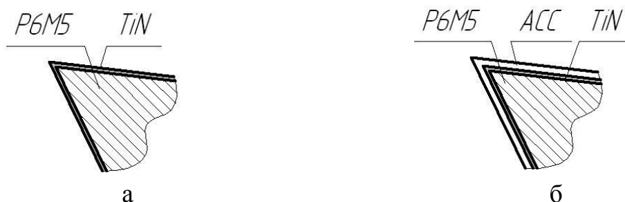
Рисунок 8 – Резцы с покрытиями: а – P6M5+TiN (низкая адгезионная активность); б – P6M5+TiN+АСС (высокая адгезионная активность)
