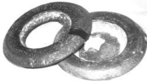
Рисунок 1 – Загальний вигляд лабораторних виливків отриманих у процесі електрошлакового відцентрового композиційного лиття
