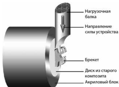
Рис. 1. Схематическое изображение теста на прочность связи
