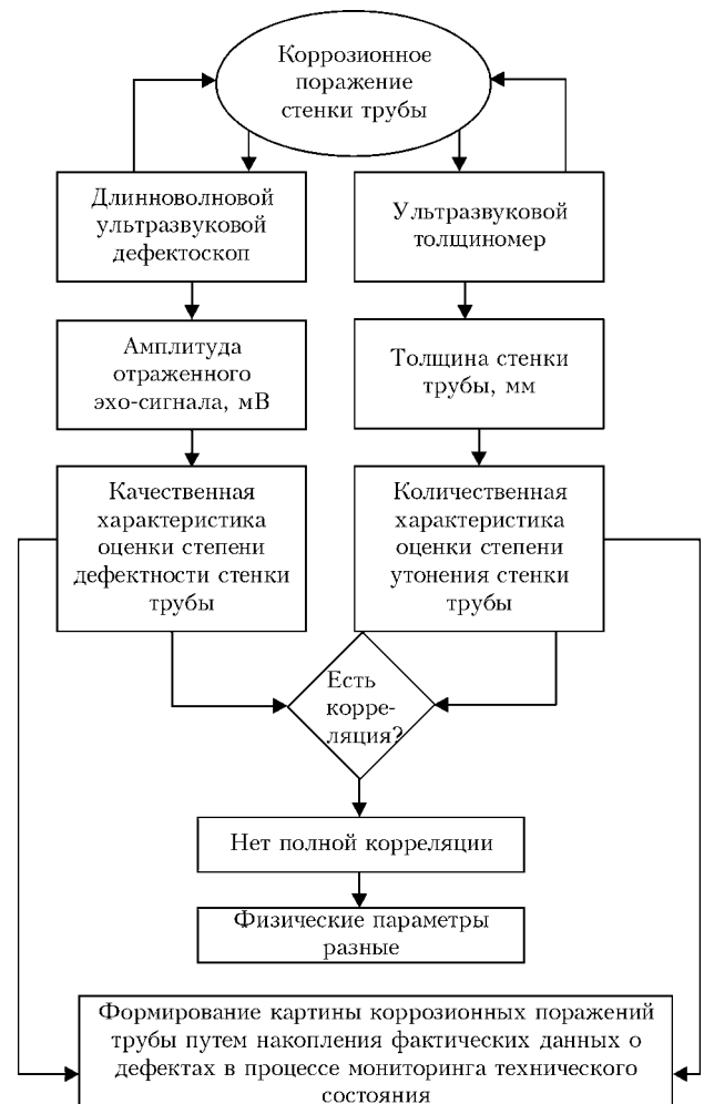
Рис. 7. Схема алгоритма оценки степени дефектности и утонения поперечного сечения трубы
