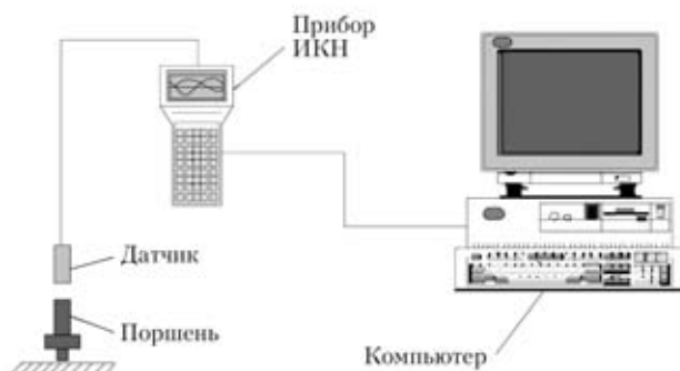
Рис. 9. Схема контроля поршней с использованием специализированного датчика и приборно-компьютерного комплекса
