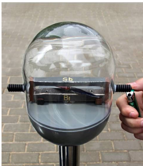
Діюча модель досліду Зеєбека Томаса Йоганна Зеєбека.
