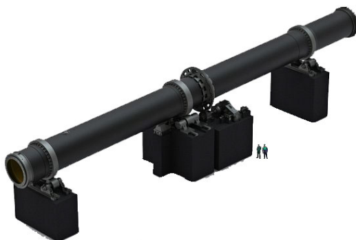
Рис. 1. Зовнішній вигляд цементної печі [10].
