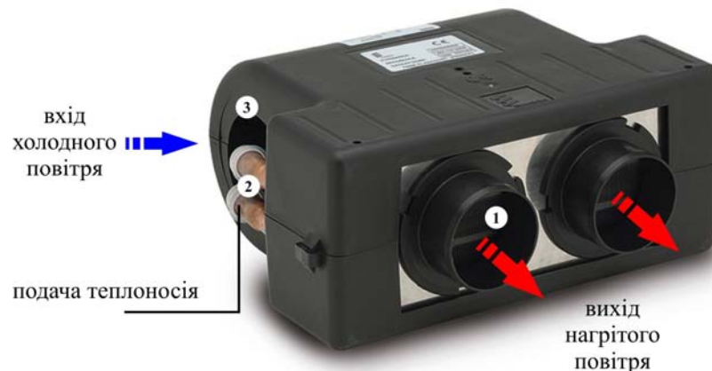
Рис.3. Неавтономний повітряний опалювач Xerox-4000 (Eberspacher): 1 – радіатор; 2 – вхідний та вихідний патрубки; 3 – вентилятор [15].
