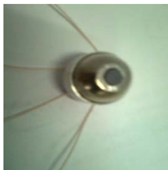
Рис. 2. Зовнішній вигляд приймача на анізотропних термоелементах (габаритні розміри 16 × 16 мм).
