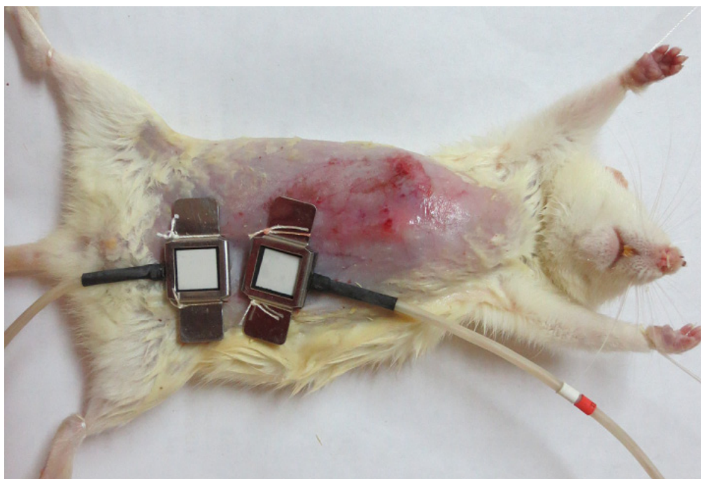
Рис. 4. Розташування та фіксація окремо вузловими швами термоелектричних сенсорів температури і теплового потоку в проекції пухлини черевної та пахової молочних залоз.
