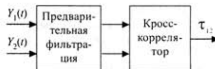
Рис. 2. Оценитель задержки сигналов на основе обобщенного коррелятора
