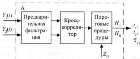
Рис. 3. Обнаружитель сигналов на основе комбинации процедур предварительной фильтрации и кросс-коррелятора
