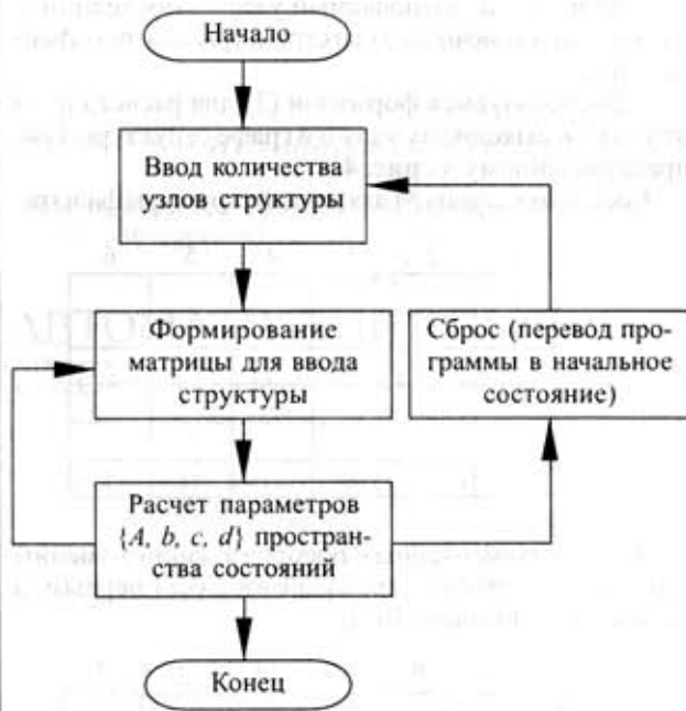
Рис. 6. Общий алгоритм программы преобразований. Целесообразно разбить его на две части: общий алгоритм программы, показывающий основные этапы работы программы, (рис. 6) и алгоритм подпрограммы расчета элементов матрицы описания структуры в пространстве состояний (рис. 7).
