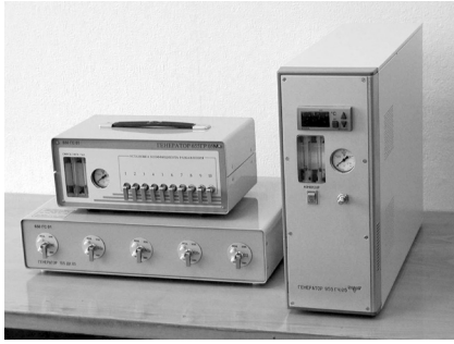
Рис. 4. Генератор поверочных газовых смесей 655ГР 05М и генератор чистого воздуха 955ГЧ 05
