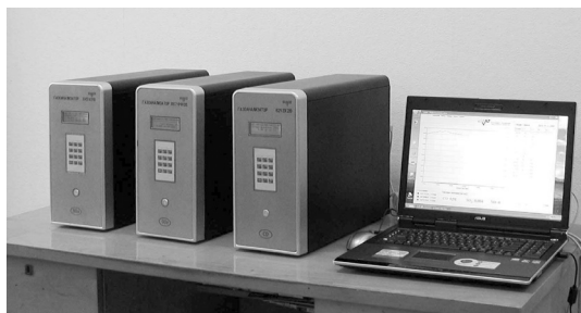
Рис. 3. Автоматические газоанализаторы 645XL 20, 667ФФ05, 621ЭХ20, входящие в систему мониторинга окружающей среды
