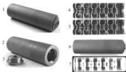
1, 6 – внешний вид глушителя; 2 – корпус; 3 – штуцер; 4, 5 – разрезанные части глушителя; 7 – рентгеновский снимок
