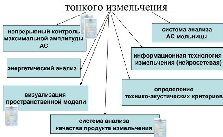
Рис. 6 – Способы оптимизации тонкого измельчения на основе результатов акустического мониторинга процесса
