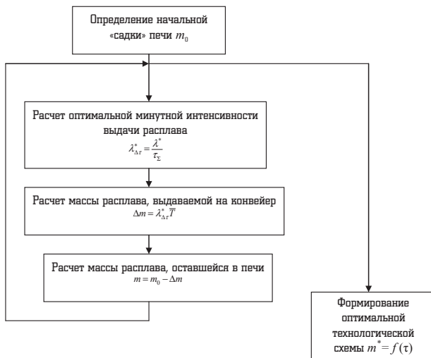
Рис. 9. Алгоритм процедуры расчета оптимальной технологической схемы плавки, закладываемой в программу управления
