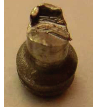
Рис. 2. Руйнування шийки штока від утоми (матеріал — сталь 08Х18Н10)
