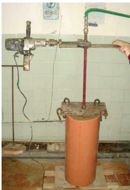
Рис. 2. Процес виготовлення ґрунтоцементних палей за бурозмішувальною технологією
