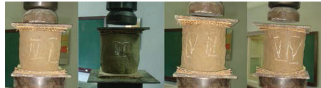
Рис. 8. Визначення міцності матеріалу палі
