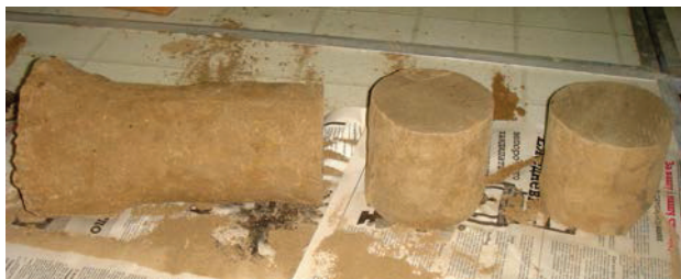
Рис. 6. Розрізання палі на зразки для випробувань
