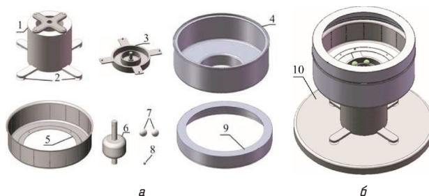
Рис. 1. Компьютерная 3D модель соковыжималки с автобалансиrom: а — 3D модели основных деталей соковыжималки и автобалансира; б — объединение деталей в сборку
