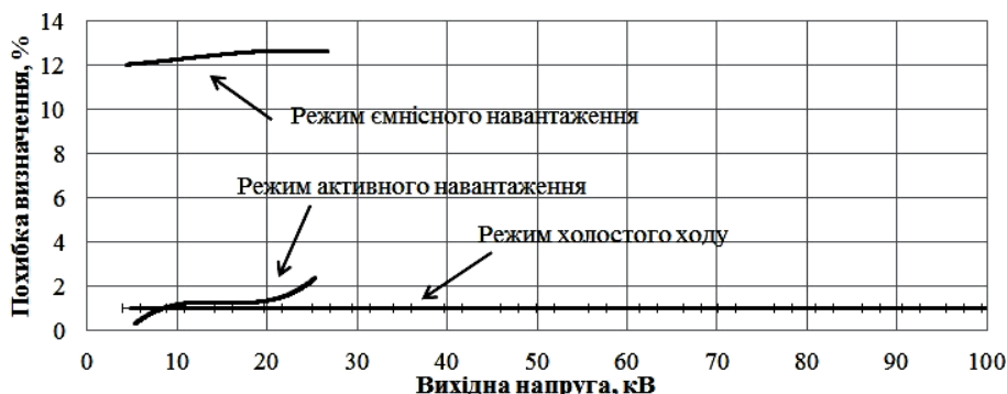
Рис. 2. Графіки залежностей похибки визначення високої напруги ИОМ-100/25 з використанням його вимірювальної обмотки для різних режимів навантаження
