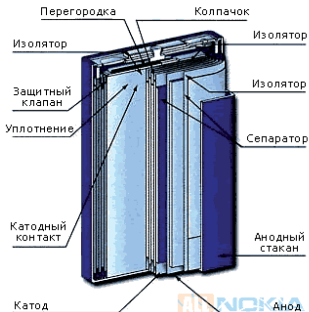
Рис. 2. Схема конструкції Li-Ion-акумулятора
