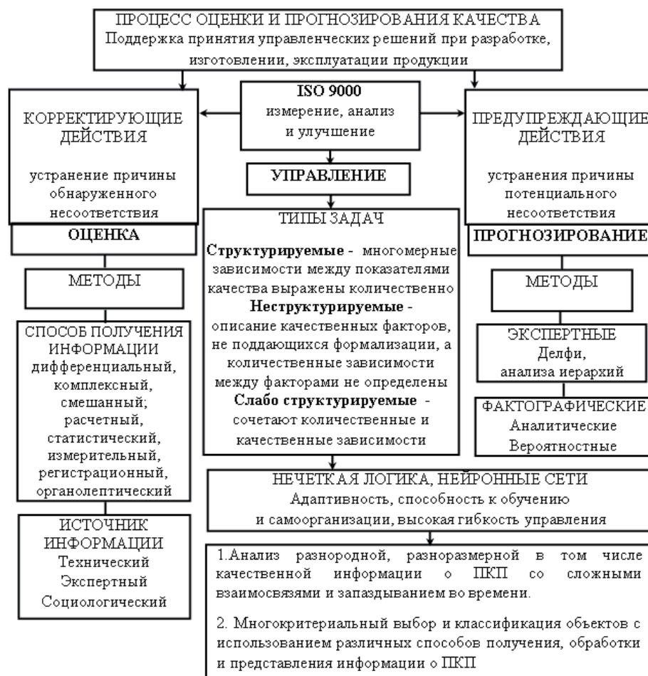
Рис. 2. Структурная схема процесса оценки и прогнозирования качества
