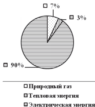
Рис. 1. Диаграмма слагаемых энергозатрат по железорудным предприятиям с подземным способом добычи руды
