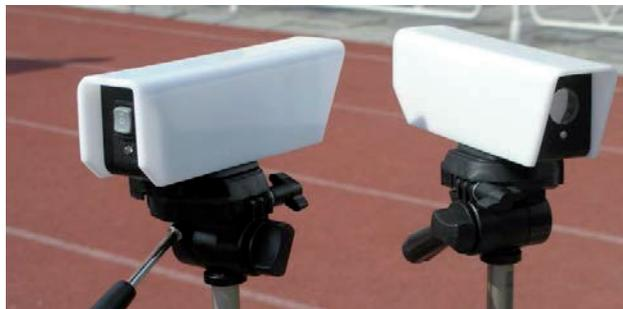
Рис. 1. Однолучевой оптический створ. ИК-излучатель и приемник разнесены
